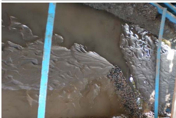
Рис. 5. Призма наносов при размещении струенаправляющей шпоры под углом 40^0 после проведения опыта с пуском расхода 11,6 л/с для природы 205 \text{ м}^3/\text{с} .
