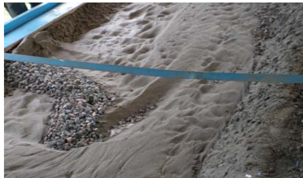
Рис. 3. Физическая модель струенаправляющей шпоры, направленной против течения по проектному варианту заказчика
